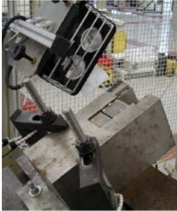
図 6.1.2: 溝の入ったテストプレートで斜めのインパクトのテストセットアップ
