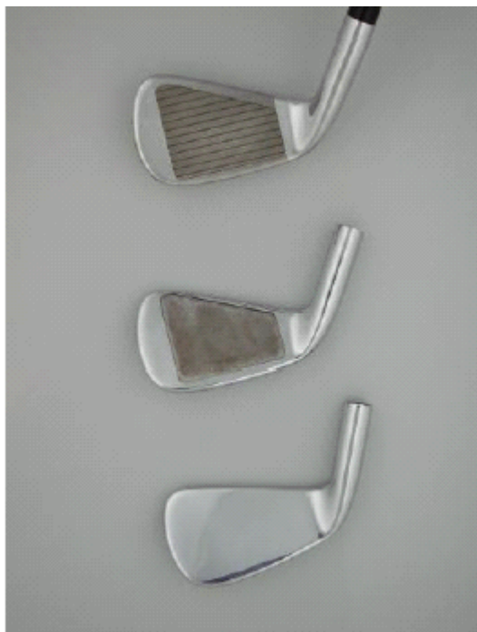
図 4.3: 溝のないクラブヘッド、ポケットの空いたクラブヘッド、仕上がったクラブヘッド
