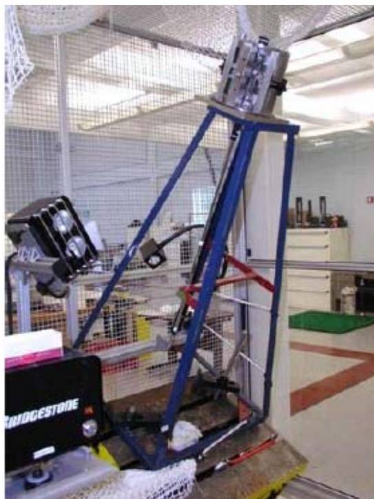
図 5.1:芝の代用物質の研究のためのテストセットアップ
